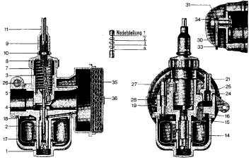
Kraftstoffmenge beeinflussen. Eine höhere Nadelstellung ergibt einen größeren Ringquerschnitt in der Nadeldüse, der mehr Kraftstoff durchläßt oder umgekehrt. "Nadelstellung 2" bedeutet dabei, daß die Düsennadel mit dem zweiten Einstich von oben in das federnde Halteplättchen (5) eingehängt ist.
