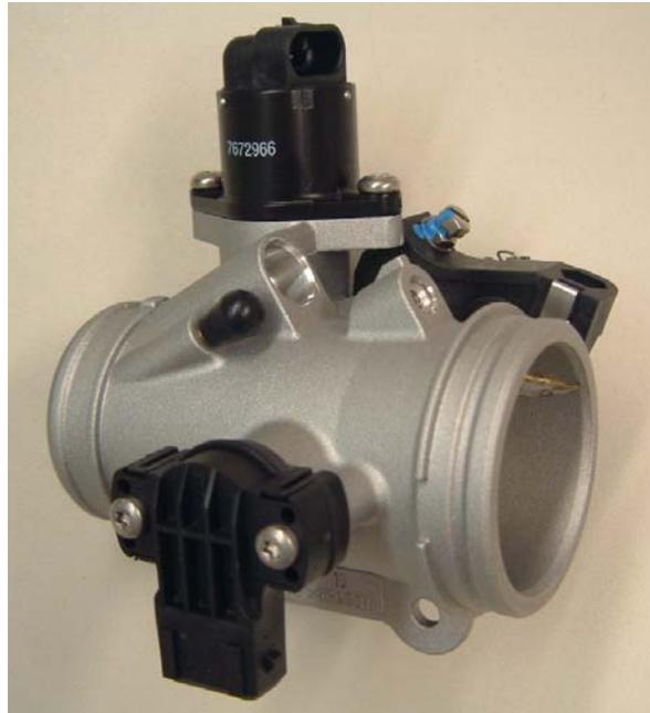
Für den BMW Boxermotor der **R 1200 GS** entwickelte BING den Klappenstutzen mit automatischer Leerlauf- und Startregelung. Der linke Stutzen ist zusätzlich mit einem Potenziometer ausgestattet. Die Gehäuse für den linken und rechten Zylinder sind mit einer neuartigen ATL Beschichtung gegen Korrosion geschützt.
