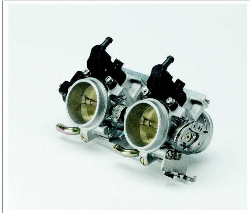
Der Drosselklappenstutzen Typ 90 ist eine Entwicklung für die 1000 S von MZ. Er verfügt über 2 Einspritzdüsen. Zur Rückmeldung des Luftdurchsatzes ist er mit einem Potentiometer als Winkelgeber ausgestattet.
