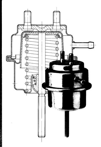
Die BING-Druckdose Typ 89 ist als Druckluft-Stellmotor für Betrieb unter hohen Temperaturen entwickelt. Sie eignet sich deshalb besonders für die Regelung von Auflade-Geräten (Beispiel: Serienverwendung für Waste-Gate-Ventil am COMPREX-Druckwellenlader).
